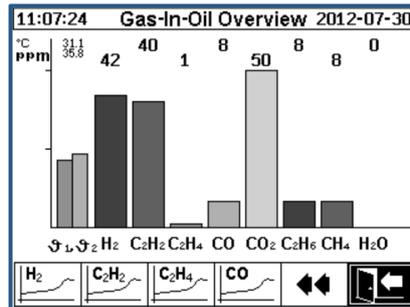
Diagrama individual para Hidrógeno (H<sub>2</sub>), Monóxido de Carbono (CO), Dióxido de Carbono (CO<sub>2</sub>), Metano (CH<sub>4</sub>) Acetileno (C<sub>2</sub>H<sub>2</sub>), Etileno (C<sub>2</sub>H<sub>4</sub>), Etano (C<sub>2</sub>H<sub>6</sub>) y Humedad (H<sub>2</sub>O).
